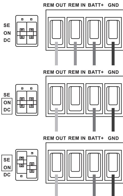
1. При подключении управляющего кабеля в разъём REM in, конвертер включается и отключается через этот кабель управления. Расположение перемычек SE-ON-DC в этом случае не имеет значения, они не будут иметь никакого действия.
